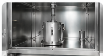
Tanque blindado con elevación eléctrica
